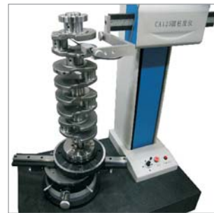
曲轴：配备定制的装夹工装，测量曲轴颈颈，拐颈的圆度圆柱度，就变的如此容易
