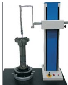
长轴内孔：只要配备加长测杆，就可以把传感器放进内孔深处测量圆度和圆柱度值
