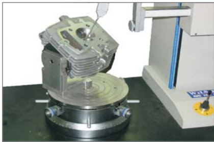
缸头：再复杂的缸头，只要配备定制的夹具，都能快速完成测量
