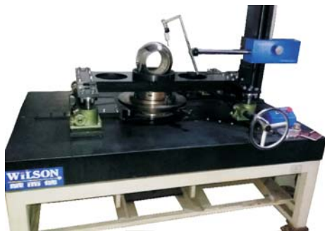
测量重600公斤,直径800mm球阀的现场图
