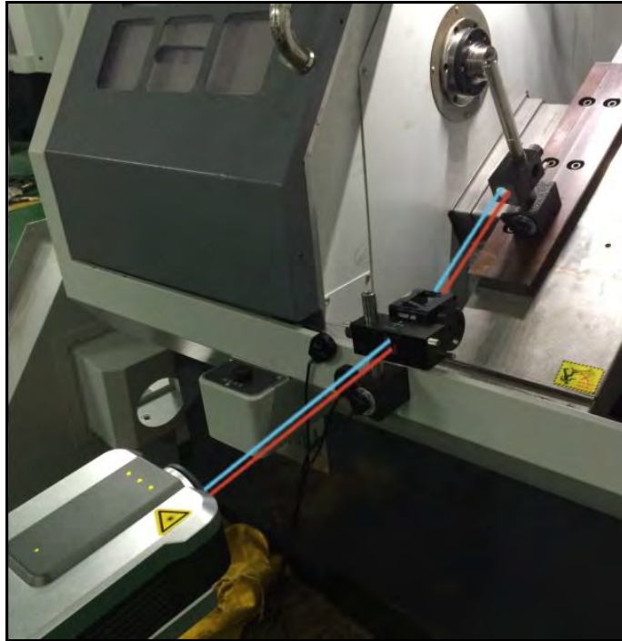
▲ 斜床的倾斜轴测量
